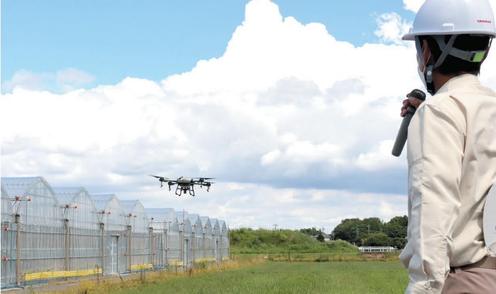
農薬散布ドローンはあらかじめプログラムされたルートで散布します。
